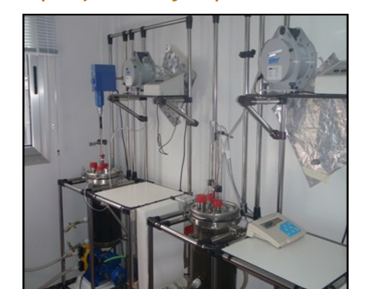
Fig. 4. Planta piloto de biogás
